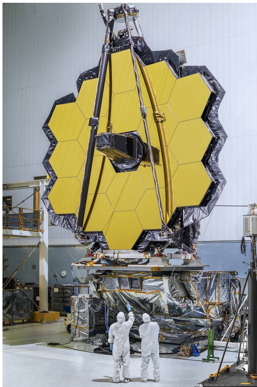
Рисунок 9. Тестовая сборка главного зеркала на земле (из Википедии)
