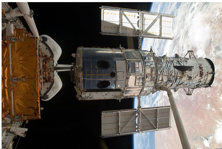
Рисунок 7. Телескоп «Хаббл» на околоземной орбите, удерживаемый робото-рукой шаттла. © NASA.
