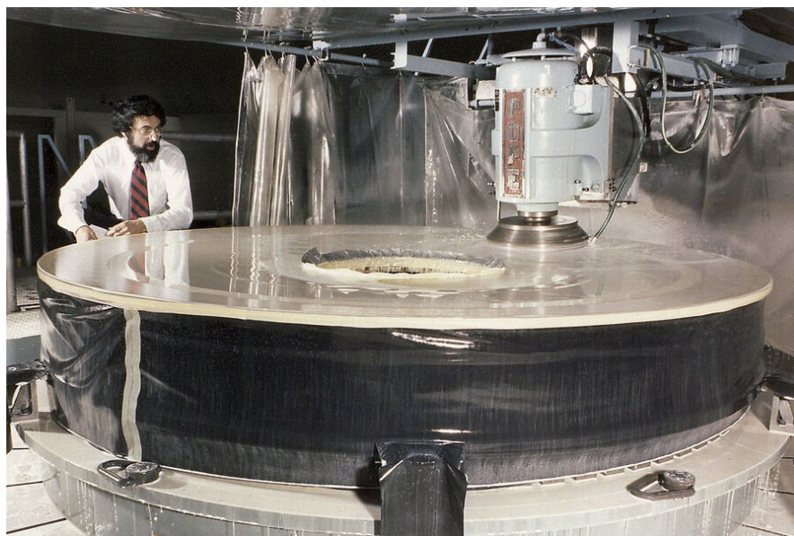
Рисунок 6. Шлифовка главного зеркала телескопа. © Nasa.
