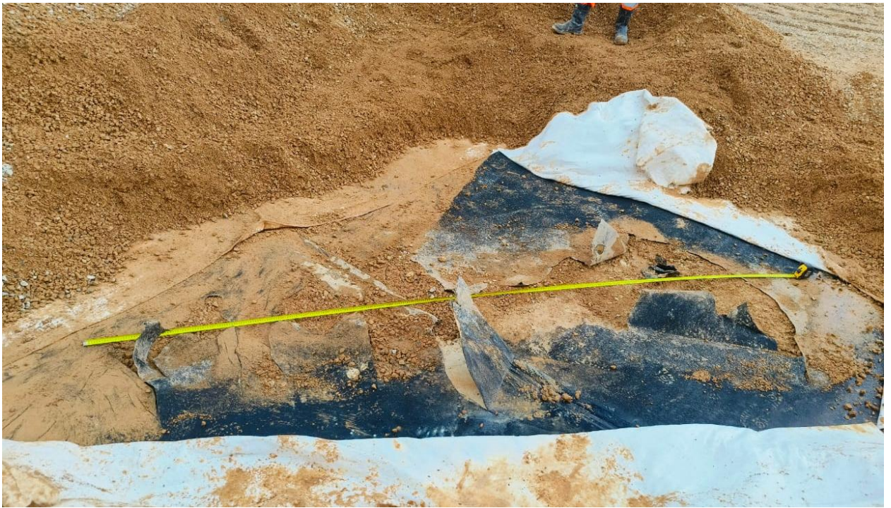
Рис. 6 Деформация 4 (примерный размер 350x125см)
