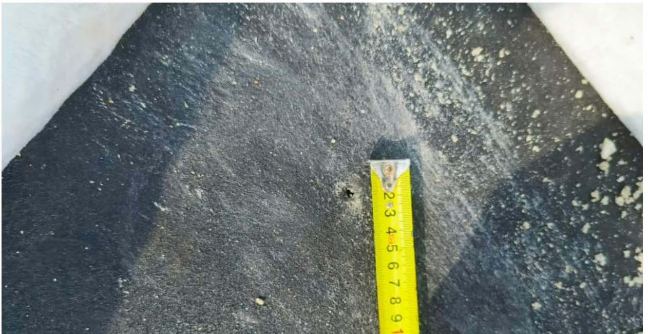
Рис. 7 Деформация 5 (примерный размер 0,5x0,5см)
