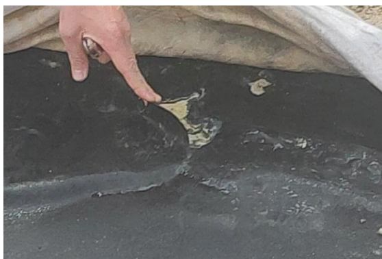
Рис. 3 Деформация 1 (примерный размер 15х20см)
